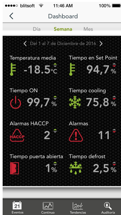
Figura 12. Dashboards específico del dispositivo AD1-4R
